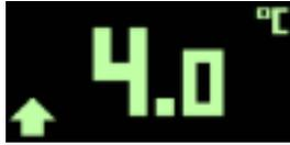
Quand les limites de température sont dépassées et le temps de retard alarme ne s'est pas écoulé, le dispositif est en état de pré-alarme. Pendant l'état de pré-alarme de haute température, l'icône FLÈCHE HAUTE apparaît. Pendant l'état de pré-alarme de basse température, l'icône FLÈCHE BASSE apparaît.
