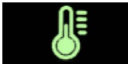
En cas d'activation d'une alarme de température dans un ou les deux compartiments l'icône « THERMOMÈTRE » apparaît, l'avertisseur s'active, le led rouge clignote et la pression de la touche INFO permet d'afficher la LISTE ÉVÈNEMENTS et de couper l'avertisseur sonore. La pression de la touche RETOUR permet de sortir de la LISTE ÉVÈNEMENTS. L'élimination de l'alarme désactive automatiquement l'avertisseur sonore.
