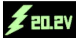
L'AVERTISSEMENT de tension d'alimentation occupe l'écran tout entier avec une icône dédiée. La pression de n'importe quelle touche, ou bien l'écoulement du temps en minutes défini par le paramètre BUF, désactive l'avertisseur sonore. Si l'évènement n'est pas résolu, il apparaît à nouveau après 24 heures.
