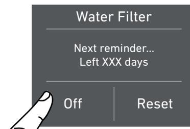
**C)** Нажмите Off (Откл.), чтобы отключить таймер.
